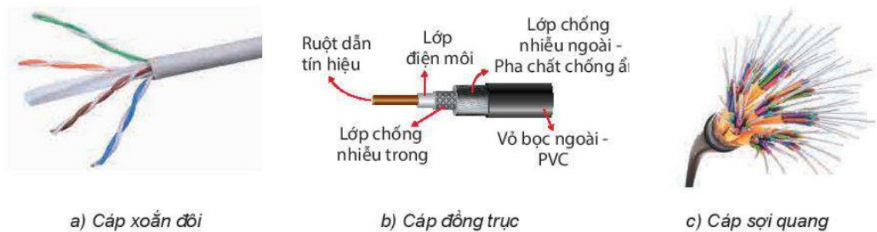
Hình 6.3. Các loại cáp truyền dẫn
