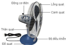
Hình 14.2. Cấu tạo của quạt điện
