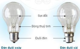
Hình 12.1. Cấu tạo đèn sợi đốt
