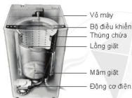
Hình 14.5. Cấu tạo của máy giặt
