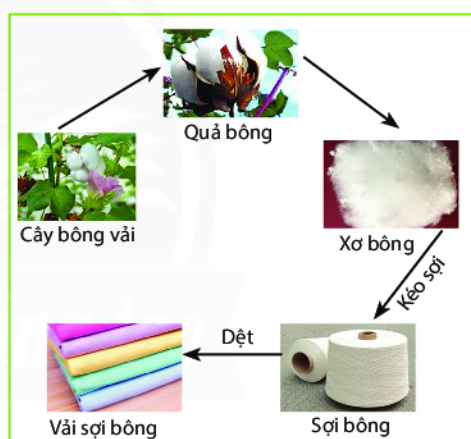
Hình 4.1. Sơ đồ quá trình sản xuất vải sợi thiên nhiên
