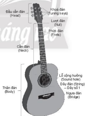
Hình 1.1. Hình dáng và cấu tạo của đàn guitar
