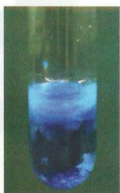
▲ Hình 13.3. Thí nghiệm cho dung dịch sodium hydroxide tác dụng với dung dịch copper(II) sulfate
