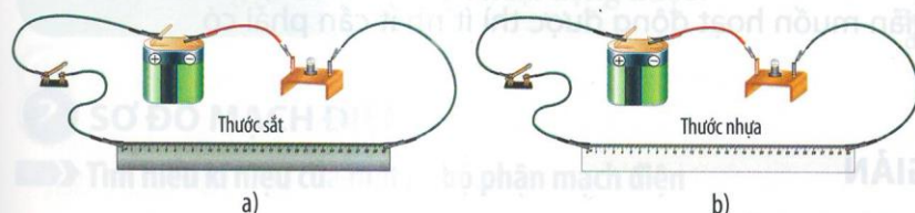
▲ Hình 22.5. Bố trí thí nghiệm tìm hiểu tính dẫn điện của chất
