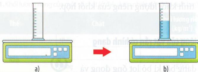
▲ Hình 15.3. a) Đo khối lượng m_d của ống đong; b) Đo khối lượng m_s của chất lỏng và ống đong
