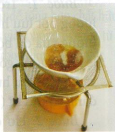
▲ Hình 3.4. Phản ứng phân hủy đường tạo thành than và hơi nước
