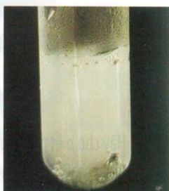
▲ Hình 3.5. Kẽm tác dụng với dung dịch hydrochloric acid tạo bọt khí
