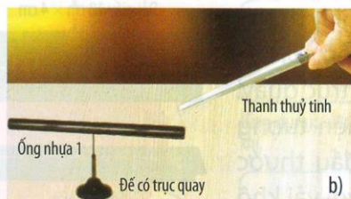
▲ Hình 21.2. Khảo sát tính chất của vật nhiễm điện: a) Ống nhựa; b) Thanh thuỷ tinh
