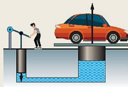
Hình 16.5 Sơ đồ nguyên lý máy nén thủy lực
