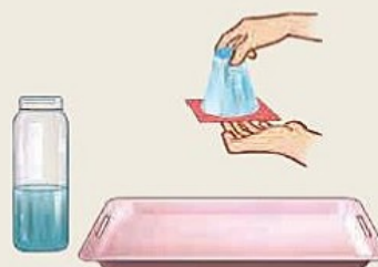
Hình 16.7 Bố trí thí nghiệm chứng tỏ tồn tại áp suất khí quyển từ dưới lên
