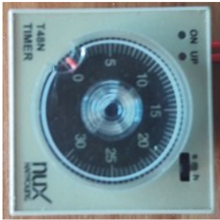
Hình 3: Mặt trước và sau của bộ điều khiển thời gian.
