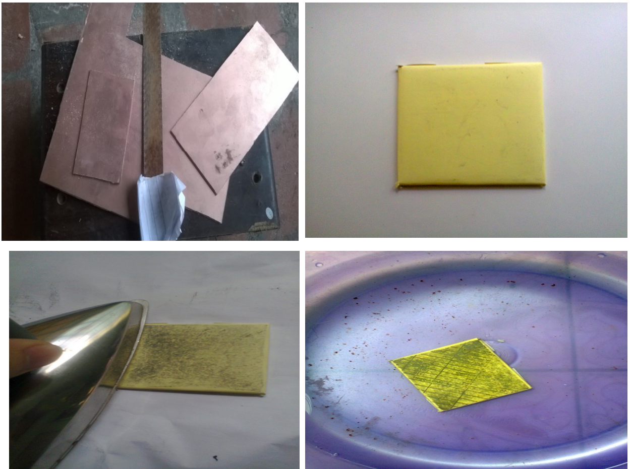
Hình 2.9: Quy trình làm board mạch
