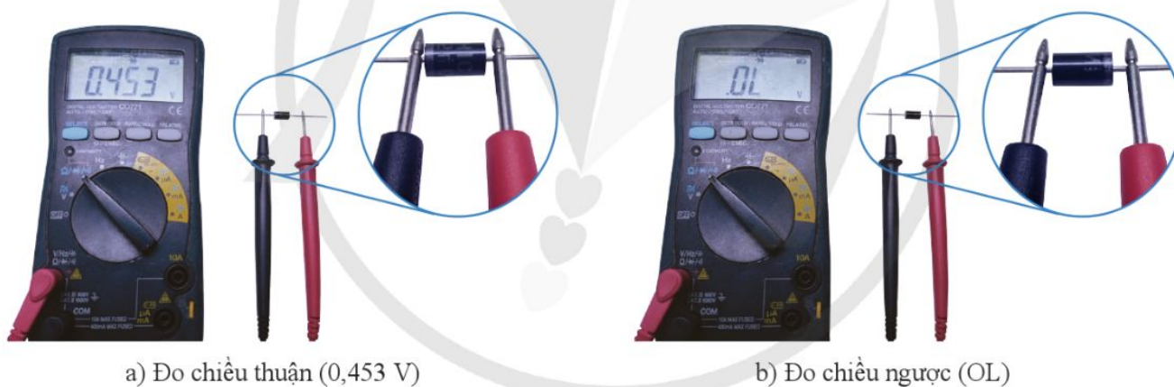
Hình 16.8. Cách đo kiểm tra diode
