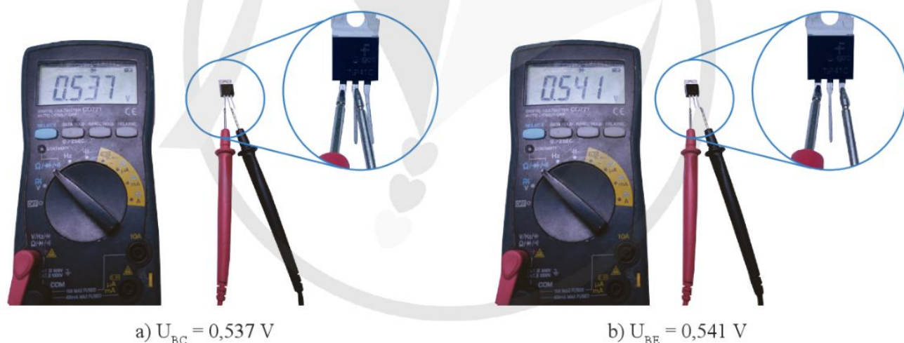
Hình 16.10. Xác định các chân của transistor TIP41C (NPN)
