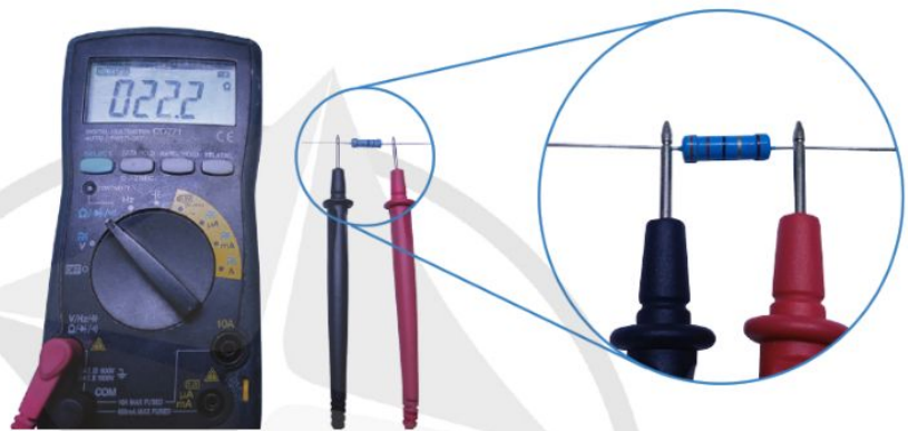
Hình 16.5. Cách đo kiểm tra điện trở bằng đồng hồ vạn năng hiển số
