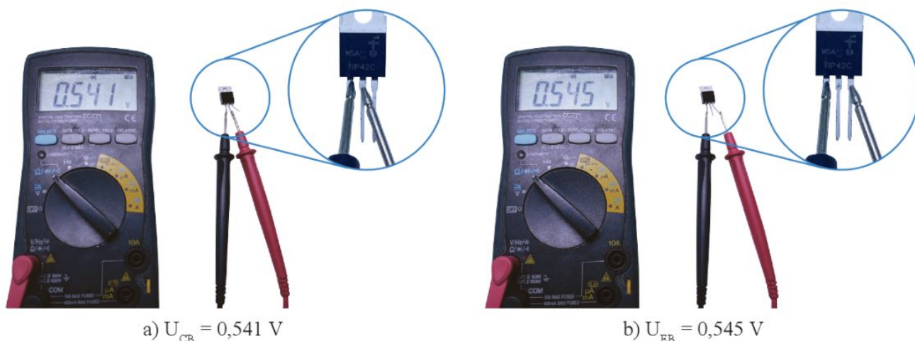
Hình 16.9. Xác định các chân của transistor TIP42C (PNP)
