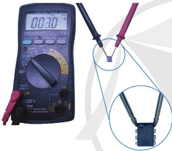
b) IC bị hỏng (đồng hồ hiển thị 3,0 \Omega )
