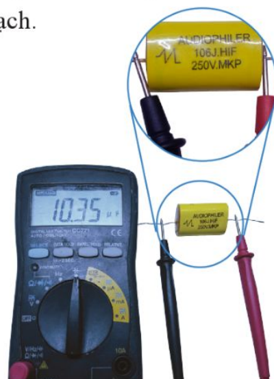
Hình 16.7. Cách đo kiểm tra tụ điện bằng đồng hồ vạn năng hiện số
