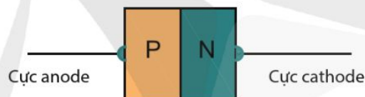
Hình 15.6. Cấu tạo diode
