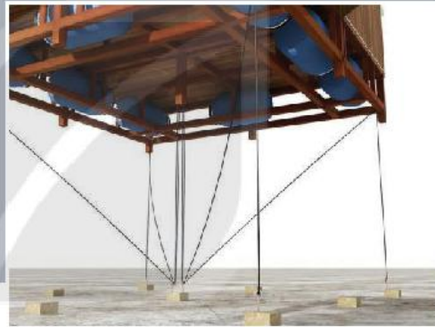
Dạng nhà nổi, bên trên là kết cấu nhẹ, dưới là thùng phuy nhựa (hoặc sắt) giúp công trình có thể nổi lên trên mặt nước trong mùa lũ. (3)
