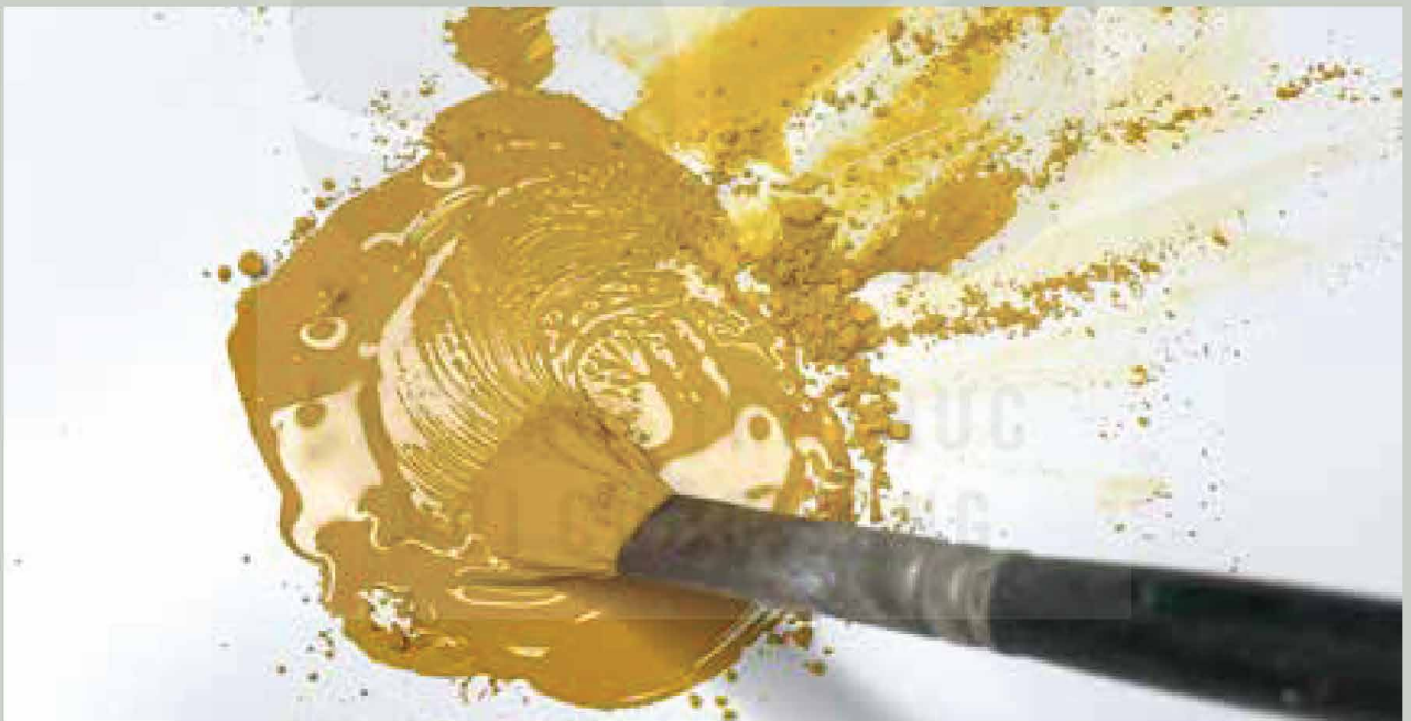
Bước 3: Thêm nước vừa đủ, dùng bút lông trộn đều để được hỗn hợp màu, keo, nước phù hợp
