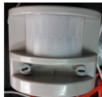
Thiết bị phát tia hồng ngoại phát hiện chuyển động của
