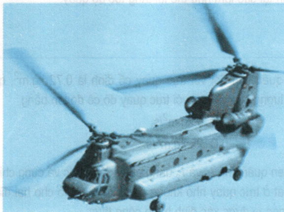
a) Loại máy bay trực thăng có hai hệ thống cánh quạt.
