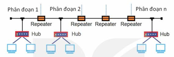
Hình 24.5. Phân đoạn mạng khi mở rộng mạng bằng repeater
