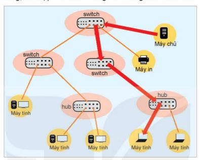
Hình 3.2. Sơ đồ một LAN sử dụng nhiều tầng switch kết hợp với hub
