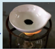
▲ Nhiệt phân \text{Cu}(\text{OH})_2 tạo thành \text{CuO}
