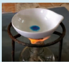
▲ Nhiệt phân \text{Cu}(\text{OH})_2 tạo thành \text{CuO}
