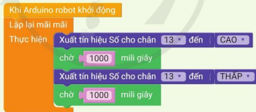
Hình 1. Chương trình điều khiển đèn LED L nhấp nháy
