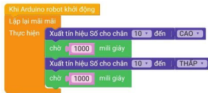
Hình 2. Chương trình mẫu điều khiển đèn LED
