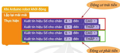
Hình 2. Chương trình điều khiển robot di chuyển tiến
