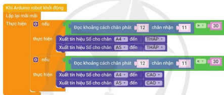
Hình 6. Chương trình mẫu Cảnh báo và chạm bằng cảm biến siêu âm
