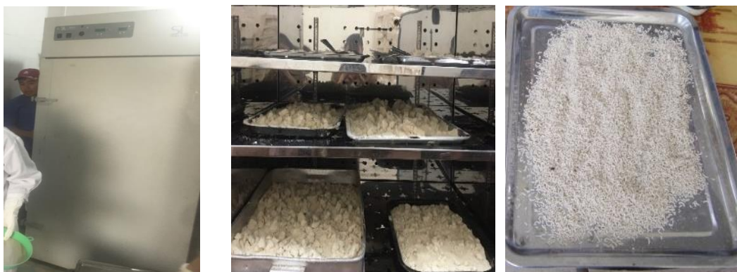
Hình 8. Công đoạn sấy bột nấm
