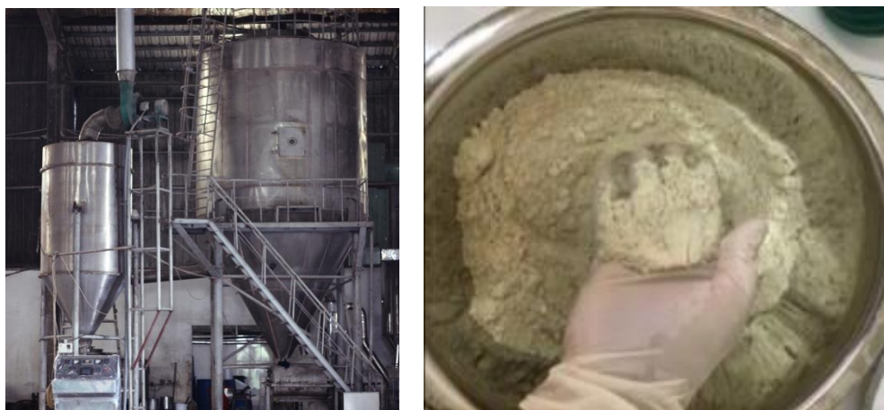
Hình 5. Công đoạn sấy tạo bột đậm thủy phân
