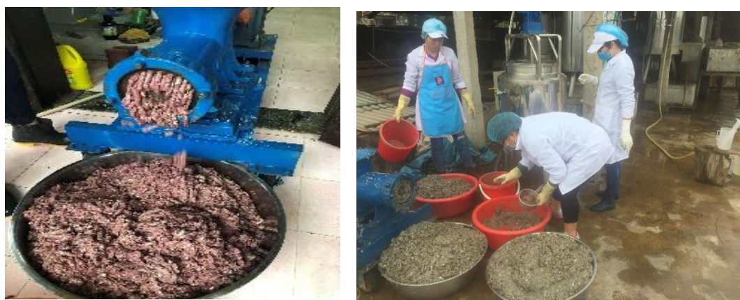
Hình 3. Công đoạn xay nguyên liệu
