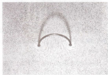
Hình 29.5 Từ phổ của dòng điện tròn.
