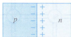
Hình 23.9 Sự hình thành lớp chuyển tiếp p-n .
