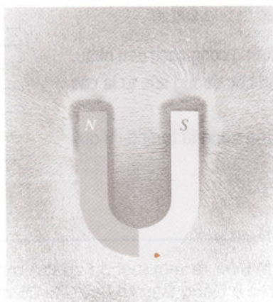
Hình 26.7 Từ phổ của nam châm hình chữ U.
