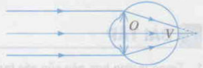
Hình 51.3 Khi không điều tiết, thấu kính mắt của mắt viễn có tiêu điểm nằm sau màng lưới.
