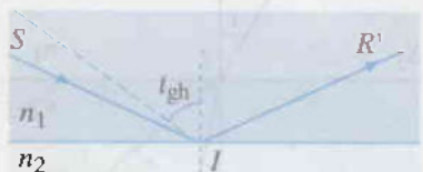
Hình 45.2 Sự khúc xạ và phản xạ của tia sáng khi tới mặt phân cách hai môi trường ( n_1 > n_2 ).
