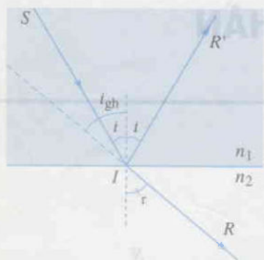
Hình 45.2 Sự khúc xạ và phản xạ của tia sáng khi tới mặt phân cách hai môi trường ( n_1 > n_2 ).
