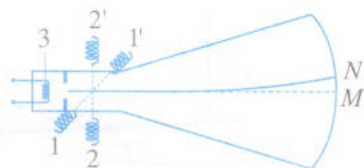
Hình 32.4 Sự lái chùm tia điện tử trong ống phóng điện tử bằng từ trường.
