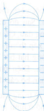
Hình 3.8 Các đường sức ở giữa hai tấm kim loại phẳng, rộng, song song, mang điện tích trái dấu, có độ lớn bằng nhau. Các đường sức này song song với nhau và cách đều nhau.
