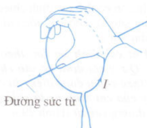
Hình 29.7 Quy tắc nắm tay phải đối với dòng điện tròn.
