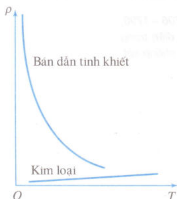
Hình 23.2 Điện trở suất của kim loại và bán dẫn tinh khiết phụ thuộc khác nhau vào nhiệt độ.
