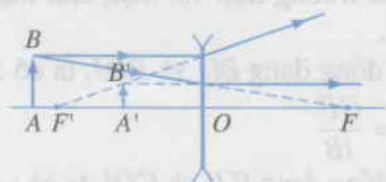
Hình 48.19 Sự tạo ảnh bởi thấu kính phân kì.
