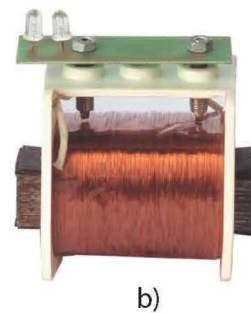
Hình 1.6 Sơ đồ mô tả cách mắc đèn LED với cuộn dây dẫn (a), cuộn dây dẫn kín có hai đèn LED (b)
