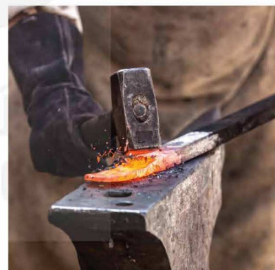
Hình 2.1 Búa chuyển động đập vào thanh thép, làm biến dạng thanh thép
