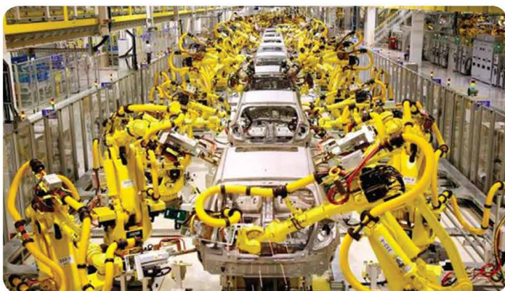
▲ Hình 2.9. Rô-bốt công nghiệp trong dây chuyền sản xuất ô tô ở Nhật Bản
