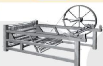
Hình 6. Máy kéo sợi Gien-ni (Giêm Ha-gri-vơ)
