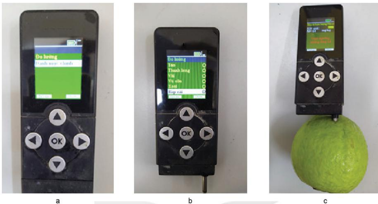
Hình 14.2. Một số bước sử dụng thiết bị đo hàm lượng nitrate
