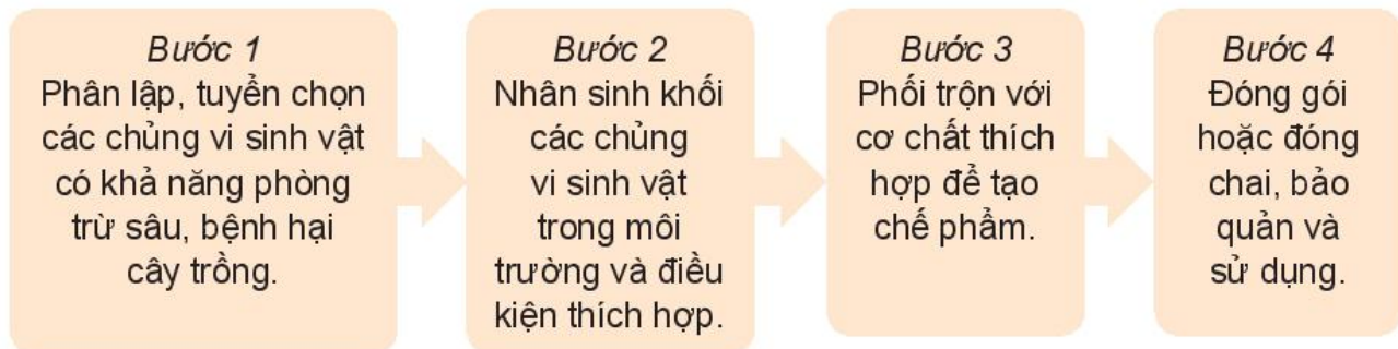
Hình 4.2. Quy trình sản xuất chế phẩm vi sinh vật phòng trừ sâu, bệnh hại cây trồng
