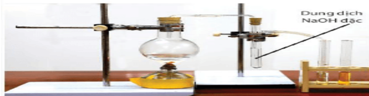
Hình 13.5. Điều chế và thử tính chất của ethylene
