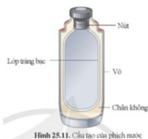
Hình 25.11. Cấu tạo của phích nước
