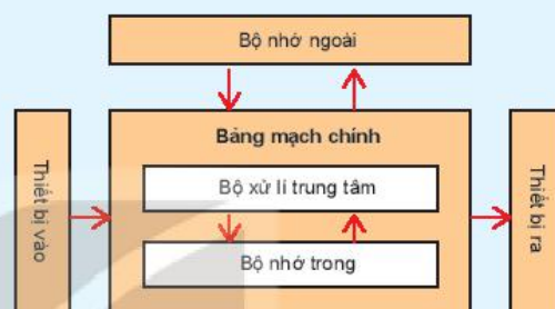
Hình 4.1. Sơ đồ cấu tạo chức năng của máy tính điện tử
