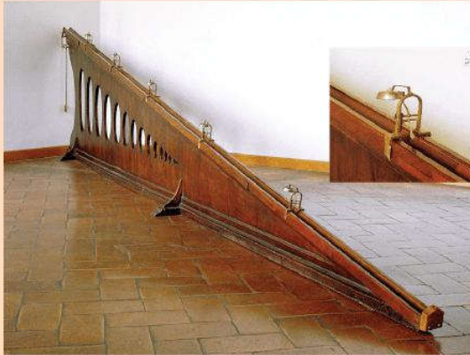
Hình 16. Dụng cụ “mặt phẳng nghiêng” đo quãng đường di chuyển sau mỗi khoảng thời gian đều nhau của Galilei tại Bảo tàng Galileo, nước Ý
