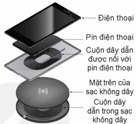
Hình 18.3. Mô tả các cuộn dây trong sạc và điện thoại
