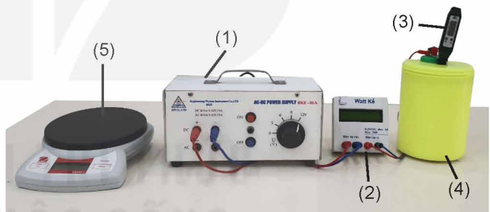
Hình 4.1. Bộ thí nghiệm thực hành đo nhiệt dung riêng của nước
