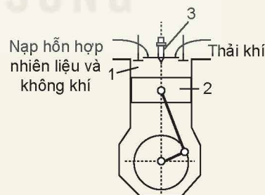
a) Sơ đồ nguyên tắc hoạt động của động cơ nhiệt
