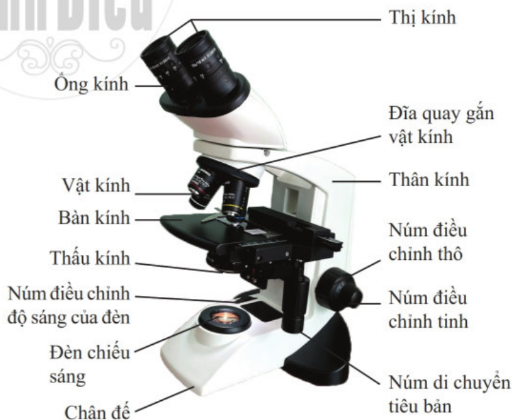
Hình 2.7. Cấu tạo kính hiển vi quang học
