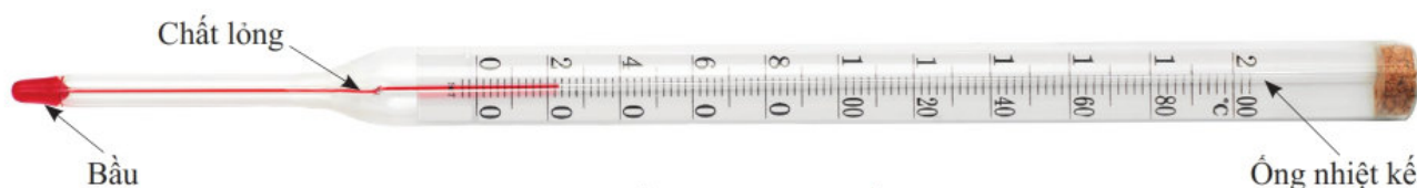
Hình 4.2. Cấu tạo của nhiệt kế
