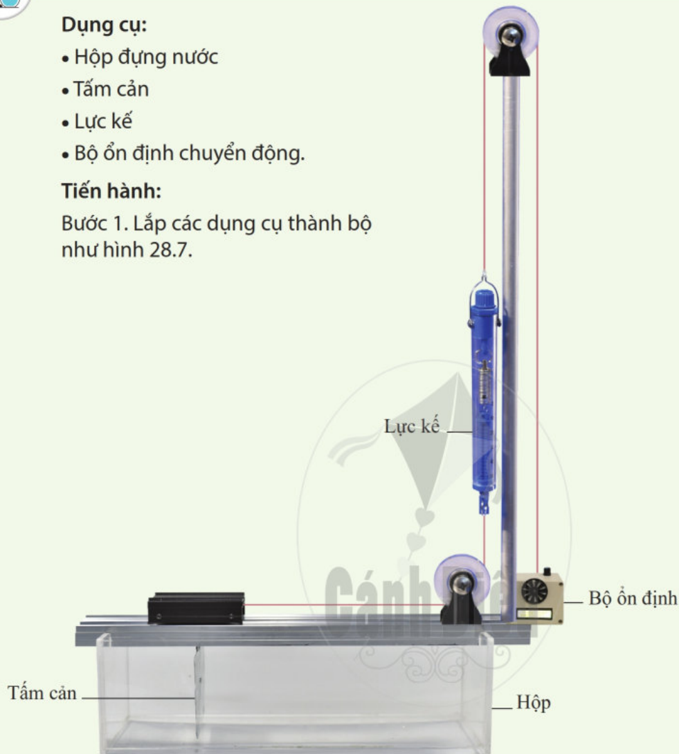
Hình 28.7. Bộ dụng cụ thí nghiệm về lực cản của nước
