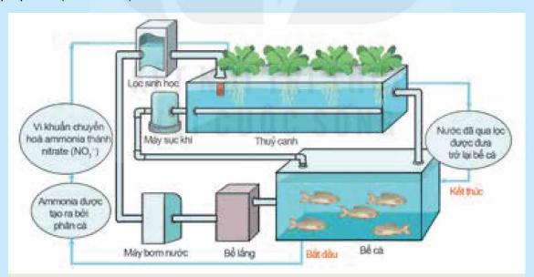
Hình 21.3. Mô hình hệ thống nuôi thuỷ sản tuần hoàn kết hợp trồng rau (Aquaponic)
