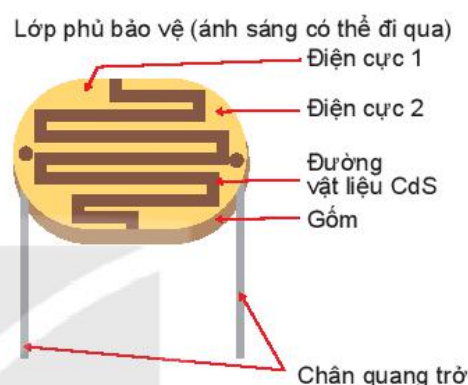
Hình 5.8. Cấu tạo của quang trở
