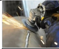
Hình 3: Mối hàn kim loại đang được mài nhẵn
