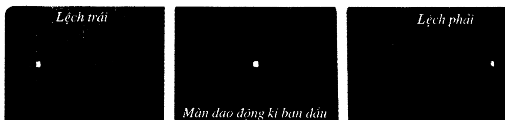
Hình 34.3. Vị trí của vệt sáng trên màn hình dao động kí điện tử.
