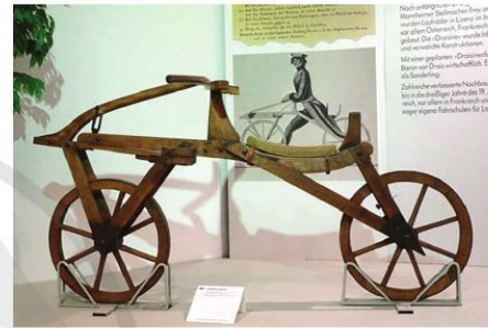
Xe có cấu tạo bằng gỗ và được bọc sắt
