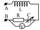
**Câu 47:** Một học sinh xác định điện dung của tụ điện bằng cách đặt điện áp  $u = U_0 \cos \omega t$  ( $U_0$  không đổi,  $\omega = 314$  rad/s) vào hai đầu một đoạn mạch gồm tụ điện có điện dung C mắc nối tiếp với biến trở R. Biết  $\frac{1}{U^2} = \frac{2}{U_0^2} + \frac{2}{U_0^2 \omega^2 C^2} \cdot \frac{1}{R^2}$ ; trong đó, điện áp U giữa hai đầu R được đo bằng đồng hồ đo điện đa năng hiện số. Dựa vào kết quả thực nghiệm được cho trên hình vẽ, học sinh này tính được giá trị của C là
