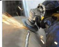
Hình 3: Mối hàn kim loại đang được mài nhẵn
