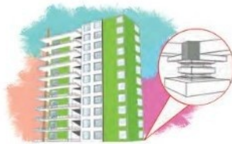
Hình 22.7. Lò xo được đặt dưới móng cọc nhà cao tầng ở Nhật Bản
