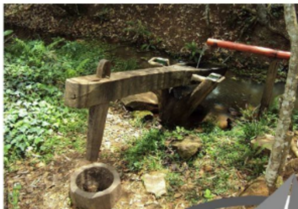
Hình 19.9. Chày giã gạo bằng sức nước
