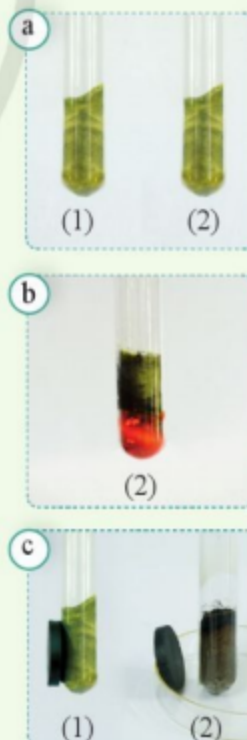
Hình 1.2. Thí nghiệm sắt tác dụng với lưu huỳnh
