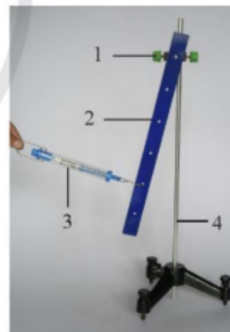
Hình 18.2. Kéo lực kế để thanh nhựa quay
