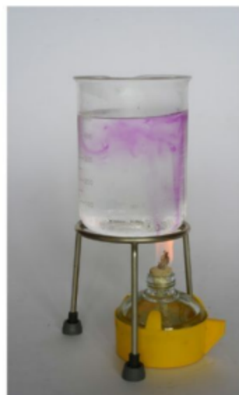
Hình 25.2. Cốc nước có thuốc tím được đun nóng
