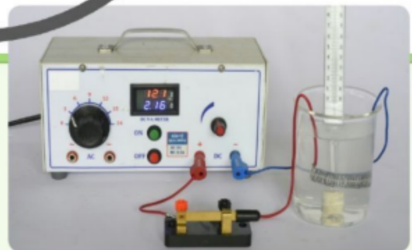
Hình 22.4. Bố trí dụng cụ thí nghiệm tìm hiểu tác dụng nhiệt của dòng điện
