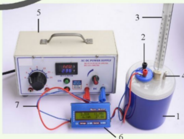
Hình 24.3. Đo năng lượng nhiệt bằng oát kế
