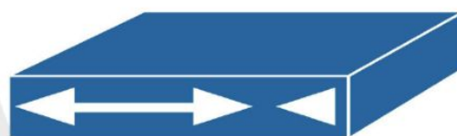
Hình 5b. Kí hiệu Modem trên sơ đồ mạng
