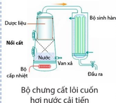
Dụng cụ chưng cất lôi cuốn hơi nước quy mô lớn
