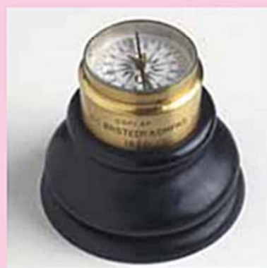
H14.21 Chiếc la bàn trong thí nghiệm của Oersted năm 1820
