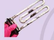
Hình ảnh bộ phận làm nóng của máy giặt sau khi tiếp xúc với nước cứng trong một thời gian dài
