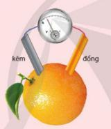
Hình 11.3. Lắp ráp pin đơn giản
