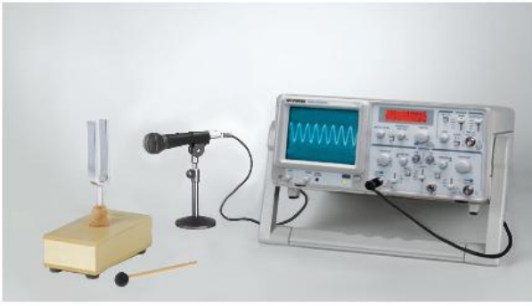
▲ Hình 13.4. Bố trí thí nghiệm quan sát đồ thị dao động âm
