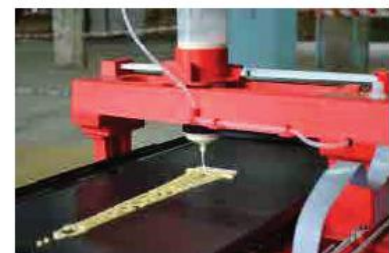
Hình 9.7. Máy in 3D sử dụng công nghệ LDM
