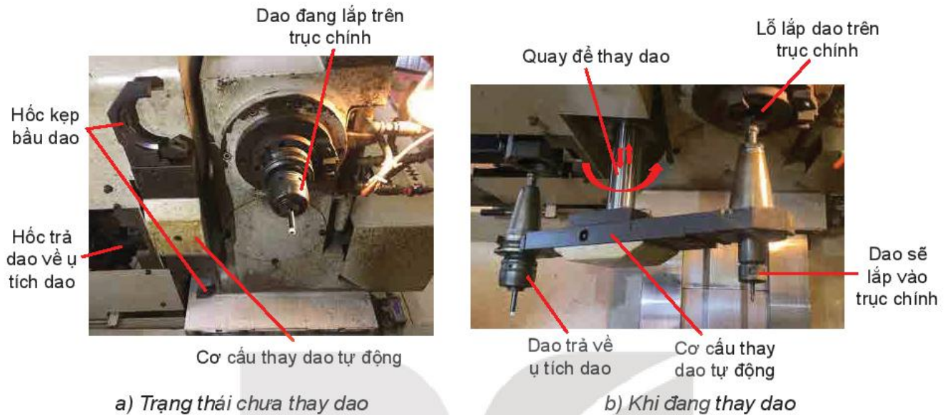
Hình 6.7. Cơ cấu thay dao tự động trên máy phay CNC
