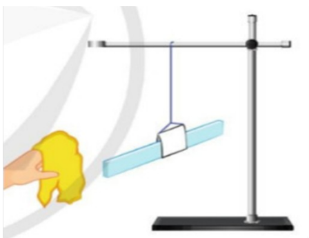
Hình 20.2. Đưa mảnh vải đã nhiễm điện lại gần thanh nhựa treo trên giá
