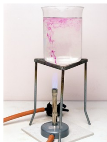
Hình 25.2. Cốc nước có thuốc tím được đun nóng
