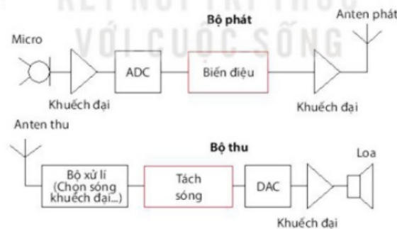
Hình 5.7. Hệ thống truyền dẫn sử dụng bộ chuyển đổi ADC và DAC
