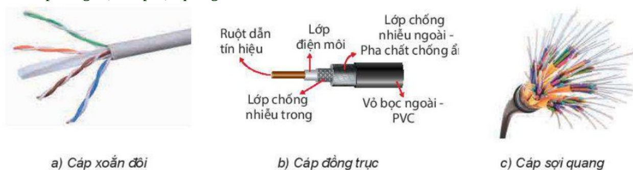
Hình 6.3. Các loại cáp truyền dẫn
