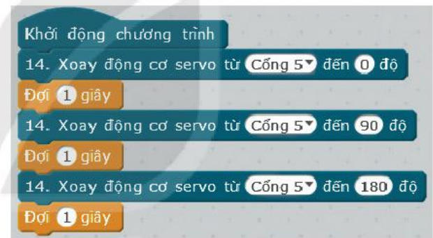
Hình 8.7. Chương trình kiểm tra động cơ servo
