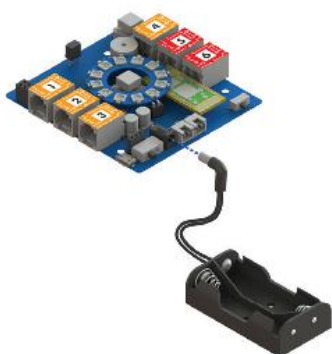
Hình 4.8. Kết nối hộp Pin với bảng mạch điều khiển
