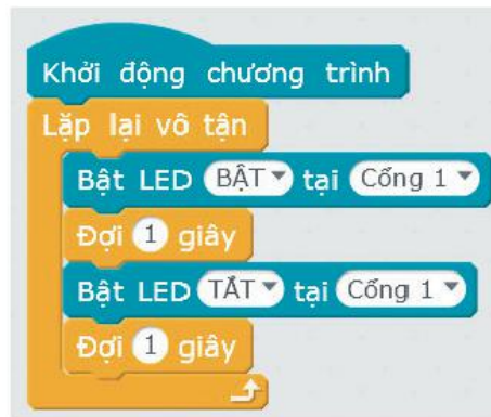
Hình 13.4. Chương trình kéo thả minh họa điều khiển đèn LED đơn sắc
