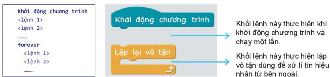
Hình 6.3. Cấu trúc chương trình điều khiển robot
