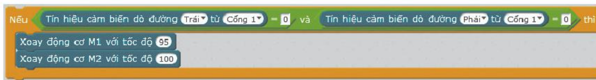
Hình 12.3. Các lệnh điều khiển robot đi thẳng bằng cách điều khiển từng động cơ
