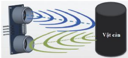
Hình 3.5. Nguyên lý hoạt động của cảm biến siêu âm
