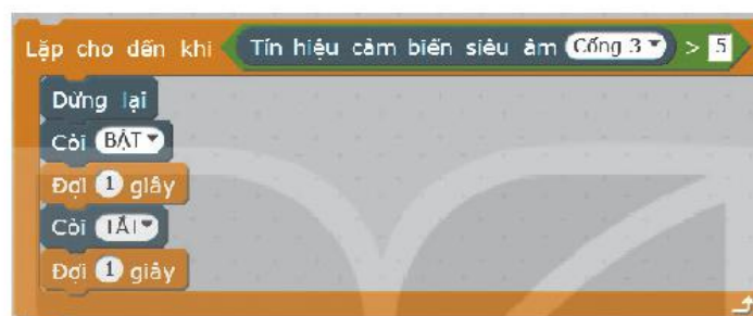
Hình 14.5. Chương trình điều khiển bật, tắt còi báo động khi robot gặp vật cản
