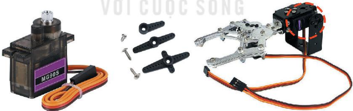
Hình 2.4. Động cơ servo và cánh tay máy gấp đồ vật
