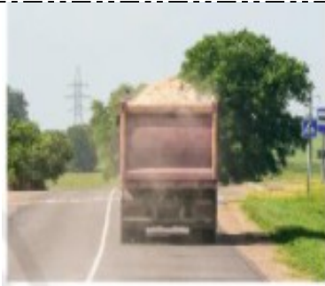
Hình 10.1. Vận chuyển vật liệu xây dựng không che bạt
