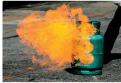
▲ Hình 12.2. Rò rỉ gas dẫn cháy nổ
